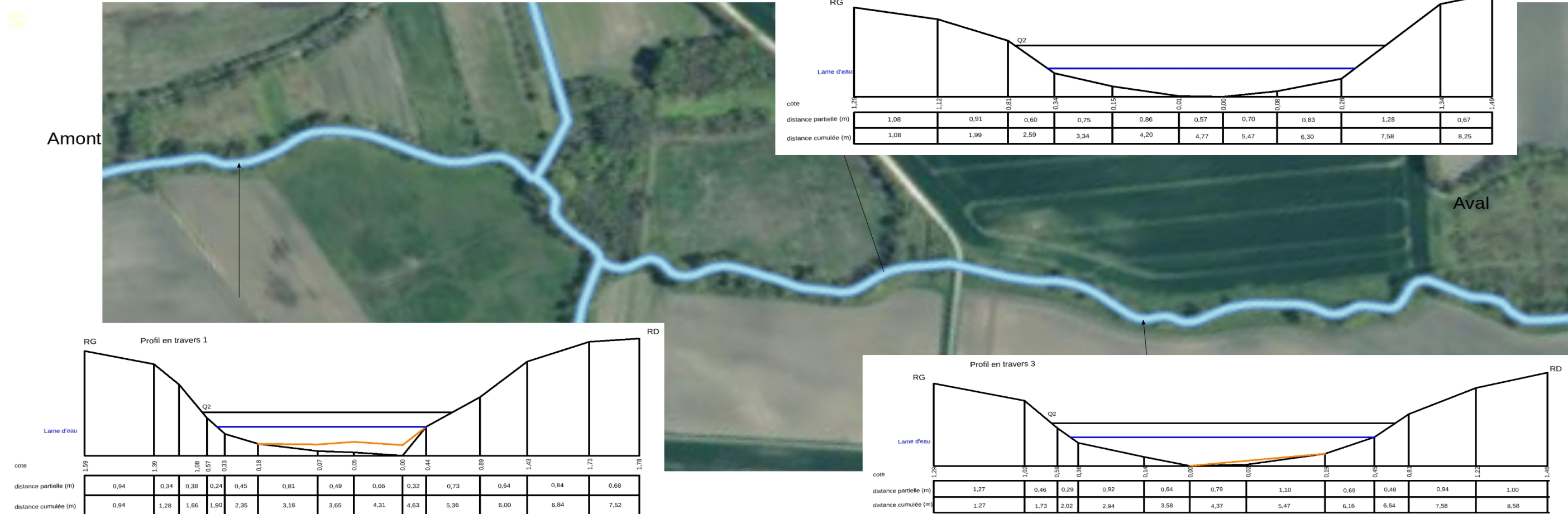
Illustration 5: Emplacement des profils en travers réalisés
